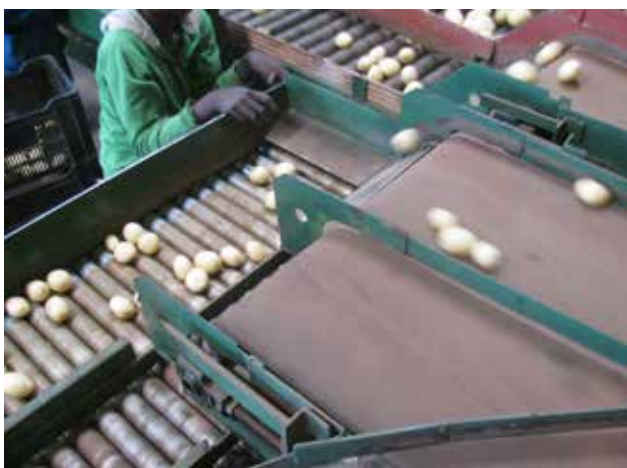
Vervoer van aartappels van die valsorteerder (drop sizer) na die Groot-groottegroepsorteertafel. Dit dui die valle op die "groot" sorteertafel aan waar daar moontlike meganiese beskadiging kan plaasvind.
